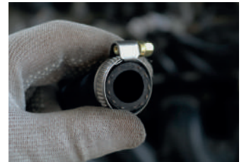
Montage von Schläuchen mit Schlauchschellen
